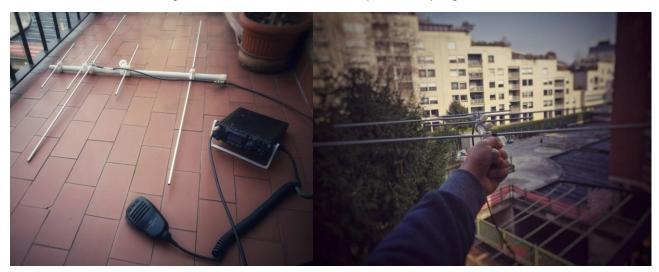
Dopo aver afferrato il ricetrasmettitore (*Yaesu FT-817*) mi sono diretto sul balcone esposto a nord e, una volta collegato il cavo RG58 con ai capi i connettori BNC, mi sono sincronizzato sulla frequenza VHF riportata sul canale degli spot MQC. Lo squelch si apre e sento: "CQ SOTA CQ SOTA IK1WEG...". Alla prima pausa trasmetto il mio nominativo con 5 W; Giovanni *IK1WEG* conferma di ricevermi chiedendomi il locatore.
